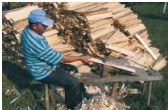
25 septembrie 2009, meșterul Găvrila verifică dacă șita a fost trasă bine
